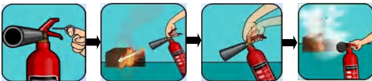
Hình ảnh: Cách sử dụng bình chữa cháy khí CO 2
